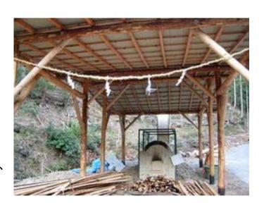
新規に築造した薪窯で本格的な作品を焼くためには、何回かのテスト焼で試行錯誤しなければならないらしい。特にこの窯は、間伐材を薪燃料として利用するので、どの程度の薪を焚けば、どのくらい温度が上がるのかが、最大のポイントのようだ。
